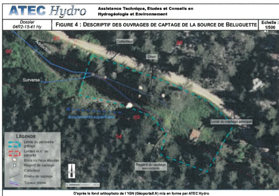
Figure 3 : Localisation des ouvrages de captage de la source de Béluguette (ATEC Hydro, 2019).
