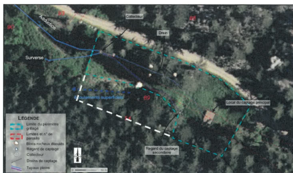
Figure 10 : La nouvelle extension du PPI (en blanc pointillé) (d'après le schéma d'ATEC Hydro, 2019)
